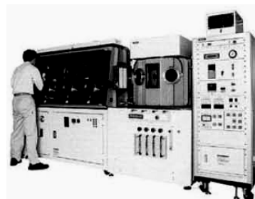
Рис. 5. Машины компании SPS Systex Inc. (Япония) для горячего прессования с нагревом пульсирующим током
